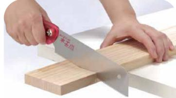
■ 刃渡り 180 mm ■ ピッチ 1.40 mm ■ 板厚 0.50 mm ■ 切り幅 0.66 mm
